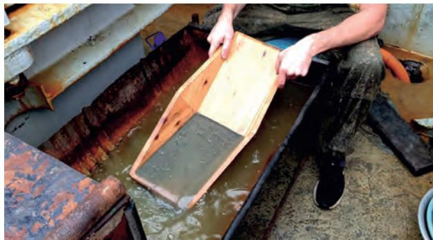
▲ Рис. 4.3. Геологический лоток типа «Канадка»
