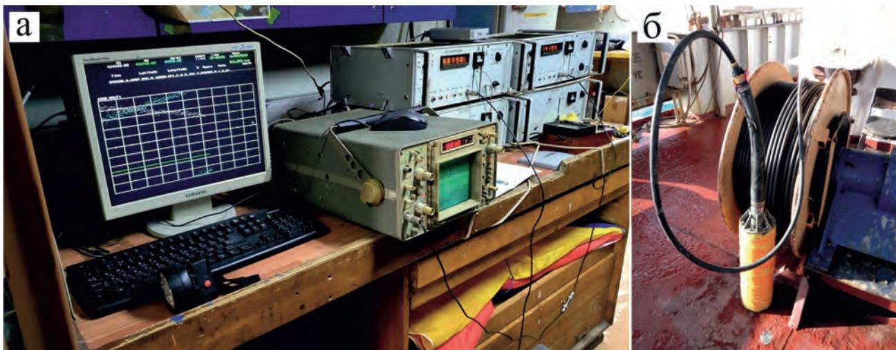
▲ Рис. 3.3. Комплект морского магнитометрического оборудования: а – магнитометр МБМ-1, осциллограф, ПК; б – катушка с гондолой
