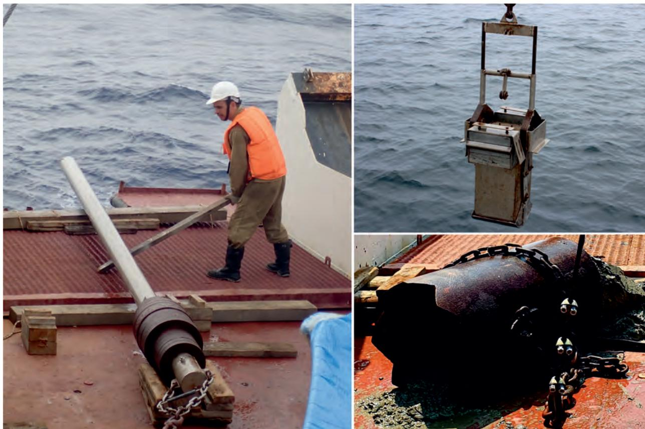
▲ **Рис. 4.2.** Оборудование отбора проб донных осадков: а – гравитационный пробоотборник; б – коробчатый пробоотборник (бокс-корер); в – геологическая драга
